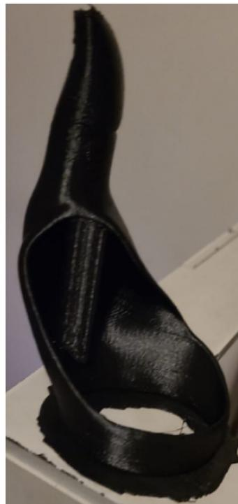
Como resultado tenemos un molde en PLA para ser inyectado en resina y de esta manera generar la prótesis de pulgar.
